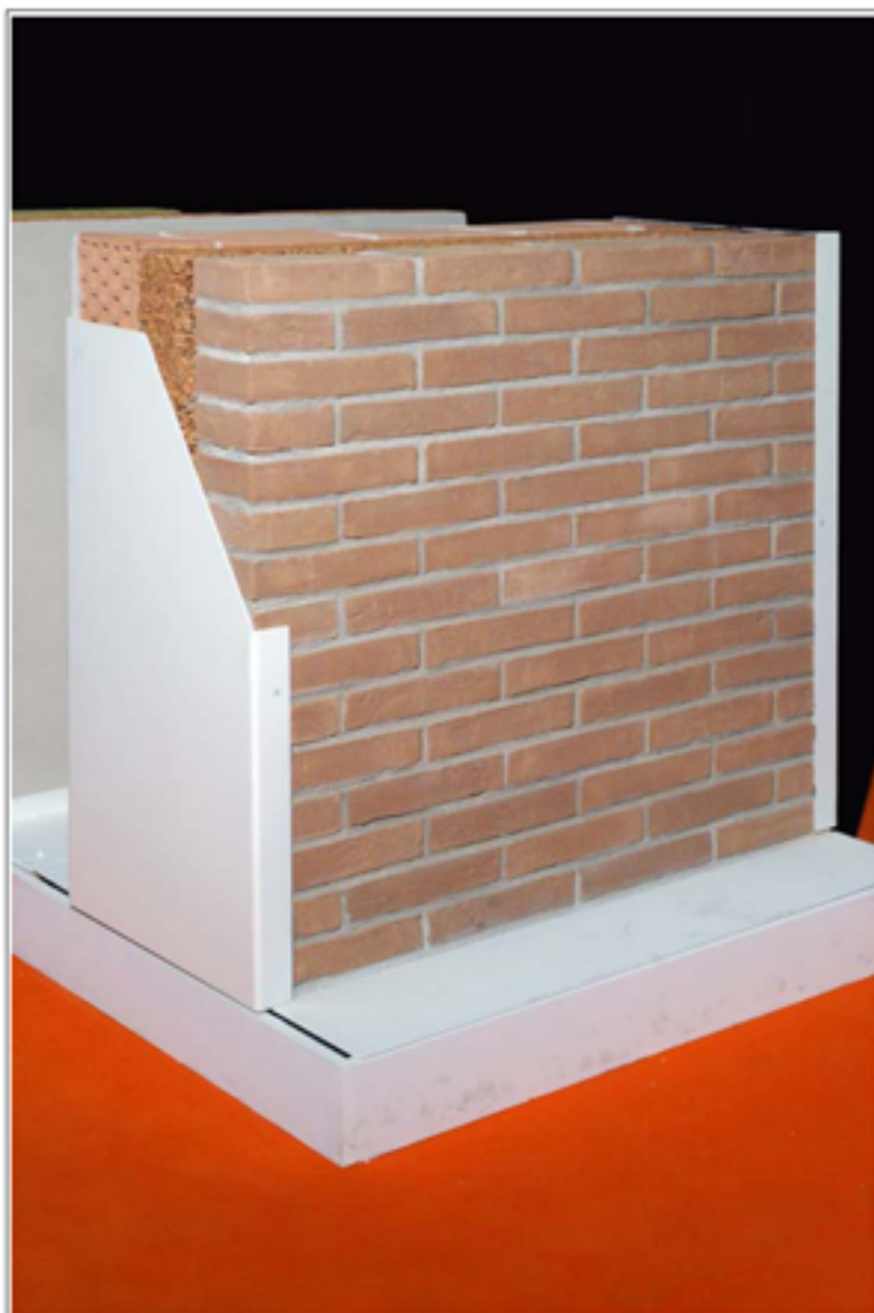
Fig. 8 - Il modello di muratura multistrato con rivestimento in laterizio faccia a vista.
