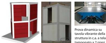
Prova dinamica su tavola vibrante della struttura in c.a. a telaio tamponato a 2 piani
