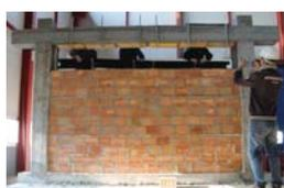
Telaio completamente tamponato (scala 1:1)
